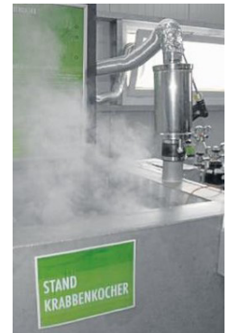
Der Krabbenkocher nutzt das Abgas und ist gut gedämmt.
